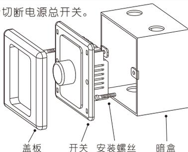
取下盖板，连接导线，安装螺丝与暗盒固定，装上盖板完成安装。
